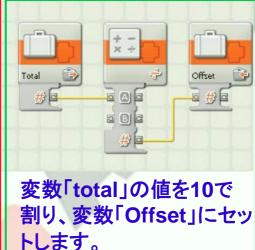
静止した状態のジャイロセンサの値を数回測定し、測定した回数で割ることで 正確なオフセット値を算出します。
