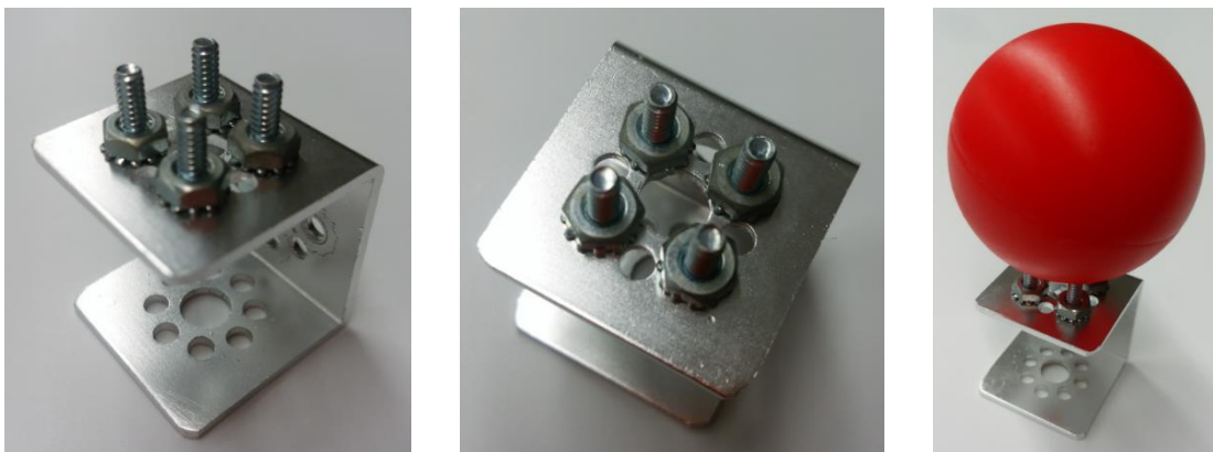
図2 TETRIX パーツで作成したボール・ラック
