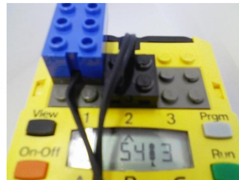
光センサが使えるようになった入力ポート2で、Viewを使ってみる(値は0から100の間の値)
