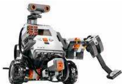
教育用レゴ マインドストーム NXT (組立例: ホッケーロボ)
