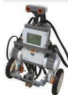
ジャイロセンサ搭載した 二輪倒立振り子ロボット
